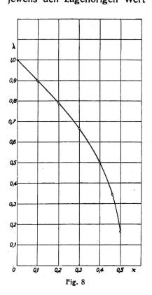
$\lambda = f(x)$  für die Werte von x = 0 bis 0,5 aufzutragen, um aus dieser Kurve den Wert von  $\lambda$  für alle Werte von  $\frac{T}{K}$  von 0 bis  $\infty$  entnehmen zu können. Diese Kurve  $\lambda = f(x)$  ist in Fig. 8 dargestellt. Zur Ermittlung des einseitigen Zuges in % des normalen vollen Zuges, der prozentualen Erhöhung des Horizontalzuges in der "Bruchspannweite"
