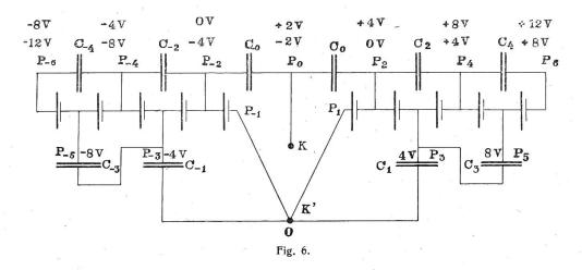
Es liegt aber im Wesen der mitgeteilten Schaltungen, dass im übrigen alle Kondensatoren ohne weiteres auf gleiche Spannung beansprucht werden, sodass man auch mit Kondensatoren kleiner Belastungsfähigkeit zu hohen Spannungen gelangen kann.
