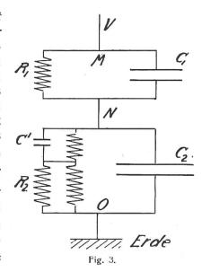
Bedingung auch nur angenähert zu erfüllen. Die Isolationswiderstände müssen also sehr hoch gemacht werden, und zwar um so höher, je kleiner die Frequenz. Für  $R_1 = R_2 = \infty$  wird  $\lambda = \frac{C_2}{C_1}$ . Praktisch dasselbe Resultat erhält man für nicht unendliche, aber sehr grosse Widerstände. Bei  $\omega = 0$  aber gilt die letzte Gleichung nur noch für so ausserordentlich hohe Widerstände, wie sie nicht mehr ausführbar wären (insbesondere wegen der Oberflächen-
