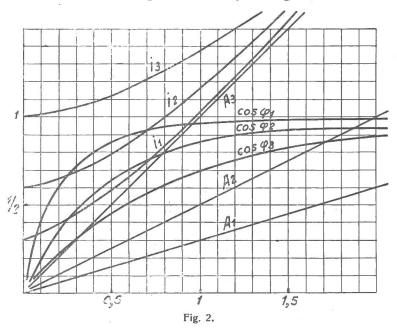
keit. Unseres Wissens ist diese Eigenschaft hier zum erstenmal bei elektrischen Maschinen verwirklicht. Für eine gegebene Zuleitungsspannung steigt die Stromstärke von einem untern Grenzwert bei Stillstand an, rascher als die Geschwindigkeit, der Leistungsfaktor nähert sich der Einheit. Für den verlustlosen Generator sind die theoretischen Kurven in Fig. 2
