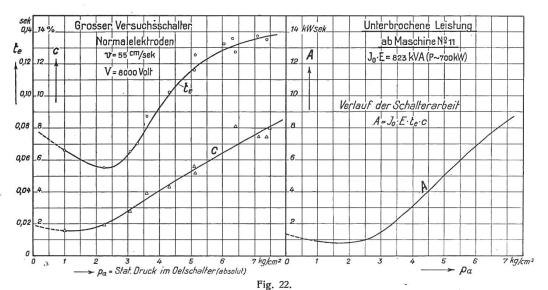
Verlauf von Lichtbogendauer, Lichtbogeneffekt und Schalterarbeit mit dem Druck im Oelschalter.
