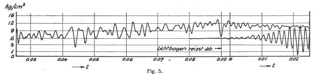
Druckverlauf im Innern des geschlossenen Oelschalters. Statischer Druck = 6 kg/cm² absolut.
