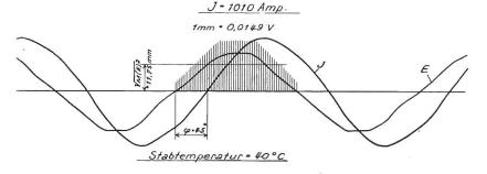
Fig.4 Eichlinie für Messungen am massiven Stab 13:36
