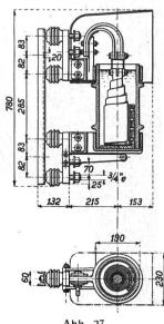
Abb. 27. Oelsicherung 2000 Amp. der A.-G. Sprecher & Schuh.
