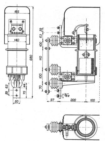
Abb. 25. Oelsicherung 800 A. 6000 V. der M.-F. O.
