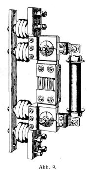
Shunt-Sicherung der M.-F. O.
