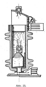
Schmelzpatrone einer Oelsicherung mit durchgeschmolzener Einlage.
