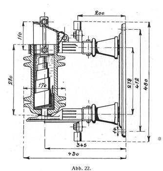
Oelsicherung der A.-G. Sprecher & Schuh (Schmelzdraht eingezogen).
