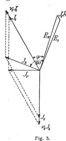
Aus dieser Gleichung ist zu ersehen, dass die Grösse der Maschine direkt mit der Schlüpfung wächst. Es empfiehlt sich daher, sofern der Drehstrommotor gleichzeitig mit dem Vibrator entworfen wird, die Schlüpfung möglichst klein zu halten, da die Mehrkosten des Rotorkupfers in der Regel reichlich durch die Ersparnisse am Vibrator ausgeglichen werden.
