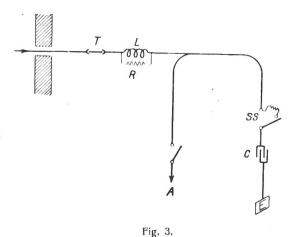
Die Verwendung des Schutzkondensators mit der Drosselspule (Ziffer 42 c).
