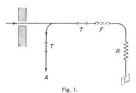
Die Verwendung der Funkenstrecke mit Dämpfungswiderstand für Spannungen bis etwa 5000 ÷ 10 000 Volt (Ziffer 42a).
