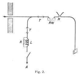
Die Verwendung des Hornapparates mit Dämpfungswiderstand und Drosselspule für Spannungen bis etwa 15000 Volt (Ziffer 42b).
