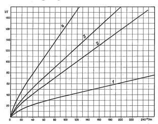
Fig. 19. Zulässige Minimalabstände zwischen den Spulen beider Schenkel.
