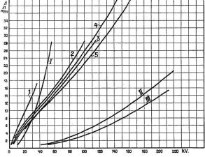
Fig. 17. Hülsenstärke als Funktion der Spannung.
