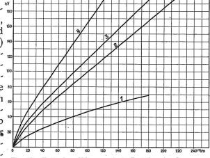
Fig. 18. Zulässiger Hülsenrand als Funktion der Spannung.
