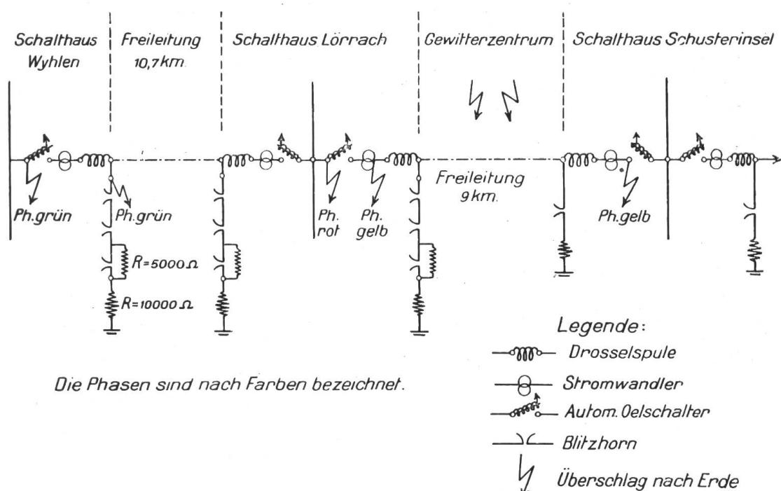
Die Schalterexplosion erklärt sich dadurch, dass alle drei Pole der Freileitung Lörrach während des Gewitters über Lichtbogen nach Erde kurzgeschlossen wurden und die Schalter diesen Kurzschlussstrom nicht zu unterbrechen vermochten. Auf dem Kurzschlussstromkreis arbeiteten zur Zeit 7 Generatoren von maximal 3000 KVA 6800—7000 Volt, 107 Touren über entsprechende Transformatoren, die von 6800 auf 45000 Volt übersetzen.
