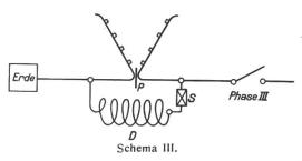
Schema III stellt ein Siemenshorn dar: ein Horn an Leitungsdraht, das andere an Erde gelegt. Parallel dazu befindet sich eine Drosselspule *D*, welcher eine feine Sicherung *S* vorgeschaltet ist. Zwischen den Hörnern ist noch ein Papierschirm *P*. Auf den Hörnern selbst sind Papierfähnchen, welche ein Funktionieren der Hörner anzeigen sollen. Wechselstrom-Entladungen werden aus bekannten Gründen nicht
