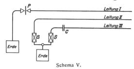
Schema V ist eine Kontrollschaltung. Ein Leitungsdraht ist mit der Funkenstrecke P verbunden, in welcher wiederum ein Papierschirm liegt. Ein weiterer Leitungsdraht ist mit einer Sicherung S verbunden, welche ihrerseits wieder an Erde gelegt ist, und der dritte Leitungsdraht ist in gleicher Weise mit einer Sicherung S an dieselbe Erde verbunden, nur befindet sich in Serie mit der Sicherung S noch ein Konden-
