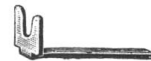
Abb. 32. Rahmenhalter, dessen gabelförmiger Teil an der Hohlchiene zwischen Gleitmutter und Sockel befestigt wird.
