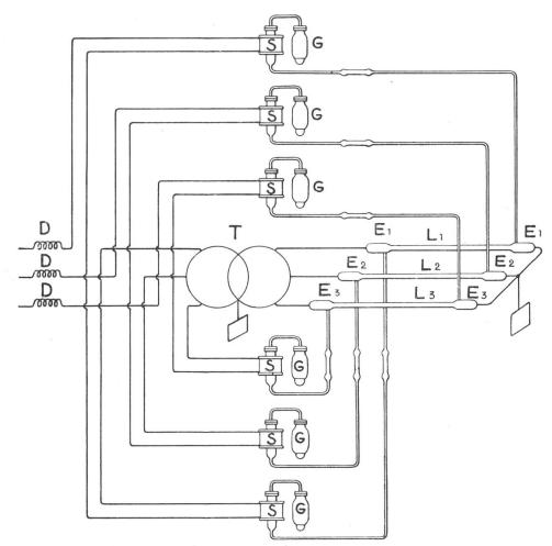
Abbildung 11. Dreiphasenstrom-Röhrenlampe mit 6 Elektroden.
