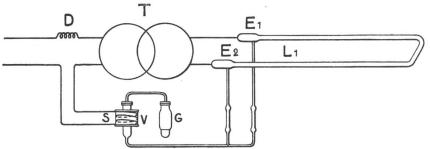
Abbildung 7. Einphasenstrom-Röhrenlampe mit 2 Elektroden.
