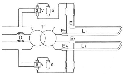
Abbildung 9. Zweiphasenstrom-Röhrenlampe.
