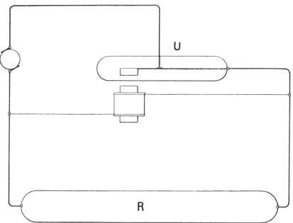
Abbildung 1. Schema einer Vakuum-Röhre mit Unterbrecher nach Moore.
