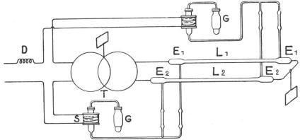
Abbildung 8. Einphasenstrom-Röhrenlampe mit 4 Elektroden.
