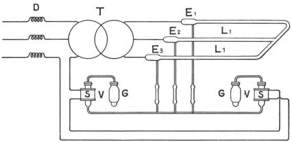
Abbildung 10. Dreiphasenstrom-Röhrenlampe mit 3 Elektroden.
