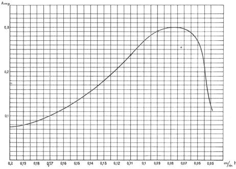
Abbildung 2. Abhängigkeit der Stromstärke vom Gasdrucke.
