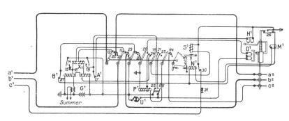
Abbildung 7. Schaltungsschema eines ersten Gruppenwählers.
