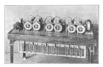
Abbildung 12. Kontaktgeber für halbautomatischen Betrieb.
