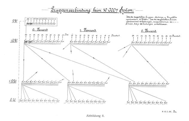
Bei Teilnehmern, die mehrere Anschlüsse im Amte haben, kann man auch die Einrichtung so treffen, dass eine besondere Vorrichtung gleich eine freie Leitung auswählt; hierdurch braucht im Teilnehmerverzeichnis nur eine Nummer geführt zu werden.
