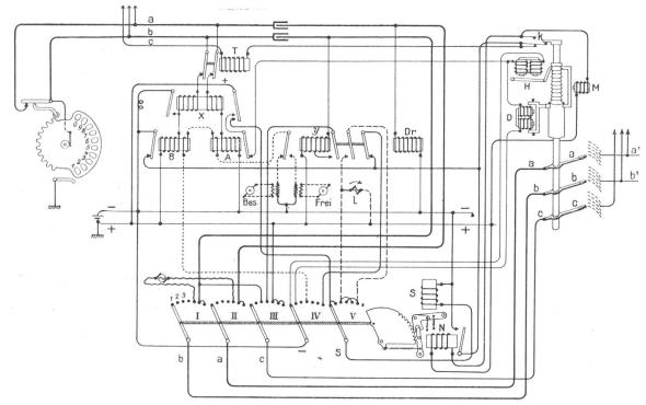
Abbildung 4a. Schema des Steuerschalters.
