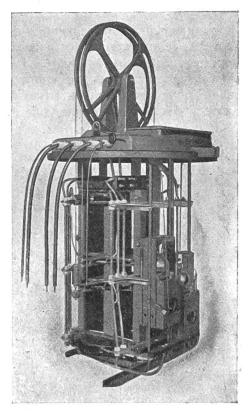
Figure 3. Transformateur-régulateur sans sa cuve.
