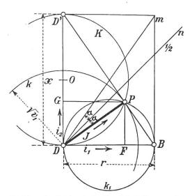
Abbildung 6. Zeichnerische Parallelschaltung zweier Wechselstromwiderstände, deren Phasenwinkel um 900 verschieden sind. Die Höhe DP parallelt die Kathetenwiderstände und die Katheten spalten den Höhenwiderstand.
