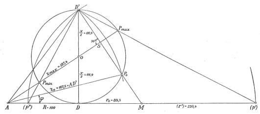
Abbildung 7. Konstruktionsblatt zum Widerstandsbild.
