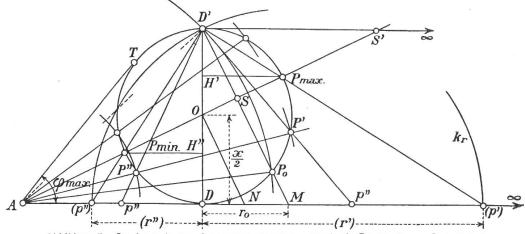
Abbildung 5. Sonderwerte des Gesamtwiderstandes z durch die Punkte Pmax, Pmin und Po.
