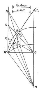
Die Ermittlung der Punkte  $R_1$ ,  $R_2$  . . geschieht durch einen Kreis aus O mit dem Halbmesser OW. Durch die Schnitte des Kreises mit  $Or_1$ ,  $Or_2$  . . werden Parallelstrahlen geführt, welche sich mit den Strahlen  $Qr_1$ ,  $Qr_2$ ... in den Punkten  $R_1$ ,  $R_2$ ... schneiden.
