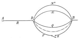
Abbildung 9. Erweitertes Leiterbild mit gespalteten Zweigwiderständen.
