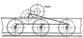
Abbildung 10. Antriebsschema der Lokomotive der Pennsylvaniabahn.
