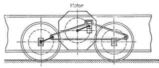
Abbildung 5. Antriebsschema aus einem Lokomotivprojekt von Brown, Boveri & Cie. in Verbindung mit der Schweizerischen Lokomotiv- und Maschinenfabrik Winterthur von 1902.
