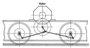
Abbildung 4. Antriebsschema der Lokomotiven der Burgdorf-Thun-Bahn von 1899.
