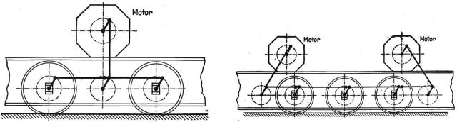
Abbildungen 8 und 9. Antriebsschemata von Lokomotiven und Lokomotivprojekte der General Electric Co und der Allgemeinen Elektrizitätsgesellschaft von 1909.
