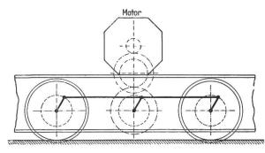
Abbildung 2. Antriebsanordnung nach Field und Eickemeyer.
