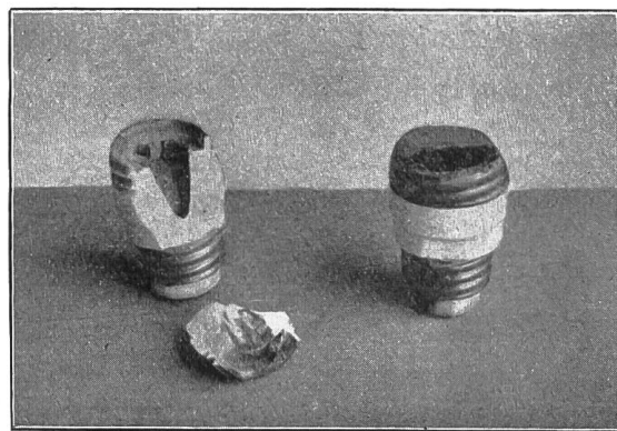
Abbildungen 6 und 7. Stöpsel für 500 Volt. 6, 30 und 60 Ampère. 20 und 30 Ampère.
