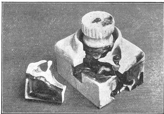
25 Ampère. Abbildungen 8 und 9. Stöpsel für 500 Volt. 30 Ampère.
