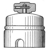
Abbildung 8. Haltbare Griffbefestigung an einem Drehschalter.
