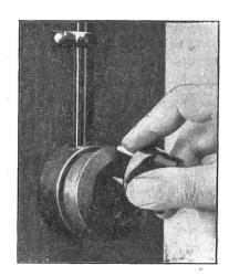
Abbildung 2. Steckdose mit Stecker, welch letzterer beiden Stiften zugleich einführen lässt und nur dann Kontakt gibt, wenn der Stecker ganz eingesteckt ist.
