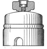
Abbildung 7. Zentrale lösbare Griffbefestigung neigt zum Lockerwerden des Griffes und der Kappe und führt schliesslich zum Abfallen der letzteren.
