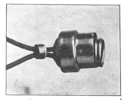
Abbildung 6. Glühlampenfassung mit ausgebrochenem, schlecht befestigtem Nippel, fehlendem Gewindering und am Körper liegendem Gewindekontakt.
