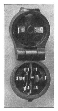
Abbildung 12. Im Innern einer Steckdose aufgetretenes Stehfeuer verschmorte die Metallteile, wurde aber von der aus Isoliermaterial bestehenden Umhüllung aufgehalten.
