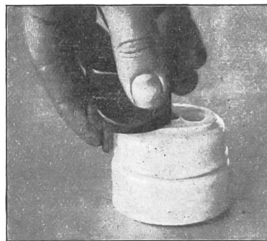
Abbildung 3. Steckdose mit Stecker, von welchem nur ein Stift in die Kontakthülse eingeführt wurde, während der andere der Berührung zugänglich ist und so Veranlassung zu einem Unfall gab.
