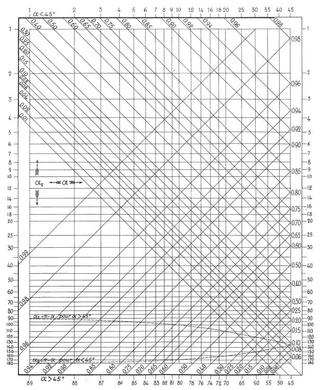
Figure 7. Abaque fournissant les valeurs de  $e^{-\alpha_2\cot\alpha}$  pour  $\alpha_2$  compris entre  $1^{\circ}$  et  $180^{\circ}$ . Exemples:  $\alpha=75^{\circ}$ ;  $\alpha_2=110^{\circ}$ ;  $e^{-\alpha_2\cot\alpha}=0.60$ .  $\alpha=62^{\circ}$ ;  $\alpha_2=37^{\circ}$ ;  $e^{-\alpha_2\cot\alpha}=0.71$ .  $\alpha=28^{\circ}$ ;  $\alpha_2=65^{\circ}$ ;  $e^{-\alpha_2\cot\alpha}=0.12$ .
