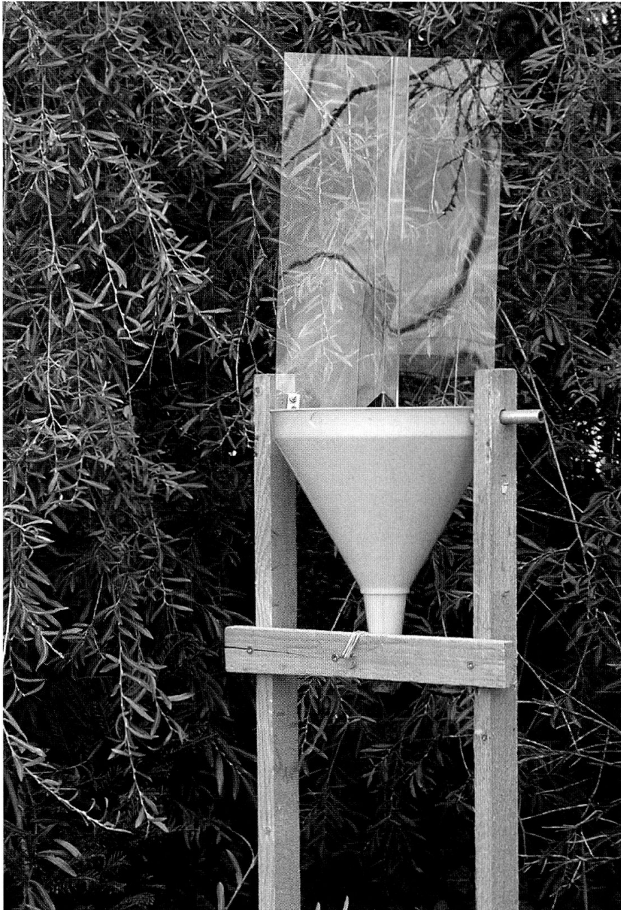
Abb. 1: Kombinationsfalle: Kombination aus Fensterfalle und Gelbschale nach Duelli et al. (1999), mit der flugfähige Insekten in der Agrarlandschaft des Reuss-Tals im Kanton Aargau, Schweiz innerhalb des EU-Projektes «Greenveins» gesammelt wurden.
