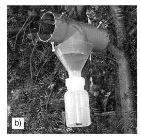
Abb. 1: Schematische Darstellung (a) und Fotografie (b) eines am Baum montierten Asteklektors.
