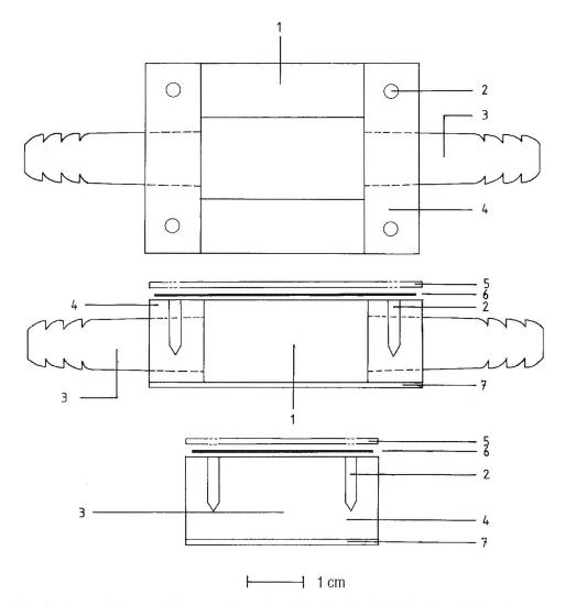
Abb.1: Beobachtungskammer. Seitenwand aus Plexiglas (1), Gewinde für Rändelschrauben zum Verschliessen der Kammer (2), Zu- und Abfluss (3), Stirnwand (4), Deckel (5), Gummidichtung (6), Glasscheibe, auf die Plexiglaswände aufgeklebt (7).
