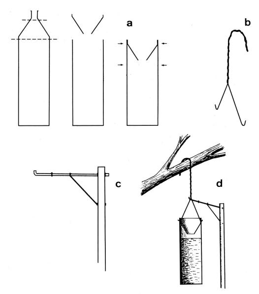
Fig. 1 a. Construction du piège à partir d'une bouteille cylindrique en P.V.C. (1,5 litre). La partie supérieure conique est découpée et sert à couvrir la partie supérieure du piège. Ce couvercle empêche les insectes de ressortir et limite l'évaporation de l'appât liquide. Les flèches indiquent les points de perçage.
