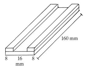
Abb. 2: Rinne aus Hartfaserplatten zur Durchführung der Versuche.
