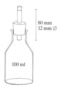
Abb. 1: Fangglas für lebende Ichneumon- $\Im$ . Im grossen Stopfen steckt ein Metallrohr ( $\varnothing$  12 mm), das mit einem Gummistopfen verschlossen werden kann.
