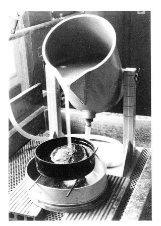
Fig. 7: Installation de lavage de terre pour récolter les stades de repos du thrips (photo Serra)
