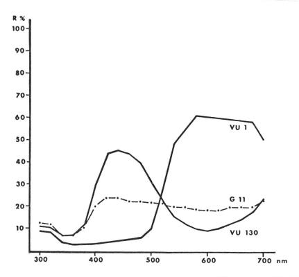
Abb. 3: Spektrale Remission der verwendeten Papiere VU 1 = gelb, VU 130 = blau und G 11 = grau. Gemessen wurde gegen gepresste Pillen von Bariumsulfat. Remission Bariumsulfat = 100%.
