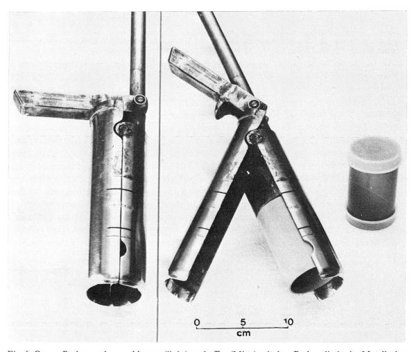
Fig. 6: Grosse Bodensonde, geschlossen (links) und offen (Mitte) mit dem Probezylinder im Metallrohr. Probezylinder mit Deckeln (rechts).
