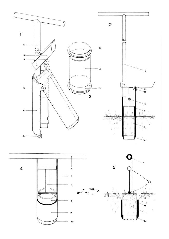
Fig. 1-5: Ansicht (1) und Schnitt (2) der grossen Bodensonde; Probezylinder mit Deckeln (3); Ansicht (4) und Schnitt (5) der kleinen Bodensonde. D, Deckel; F, Flacheisen; G, Griff; M, Metallrohr; N, Nocken; R, Riegel (kleine Sonde); Ri, Riegel (grosse Sonde); S, Scharnier; Sc, Schneide; Z, Probezylinder.
