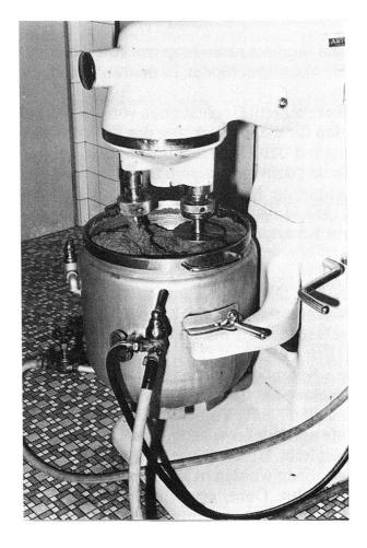
Abb. 1: Zubereitung des Nährbodens; Planetenrührwerk mit 60 Liter Doppelwandkessel für Dampfbeheizung (Photo A. Staub).
