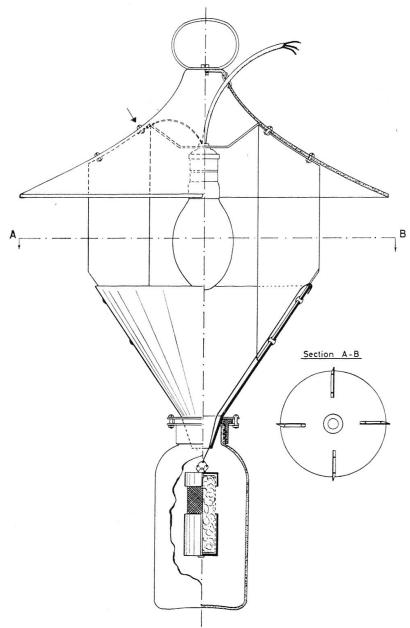
Fig. 6. — Dessin schématique du piège « Changins » (env. 1/5 de la grandeur naturelle).
