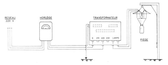
Fig. 7. — Schéma de l'installation électrique.
