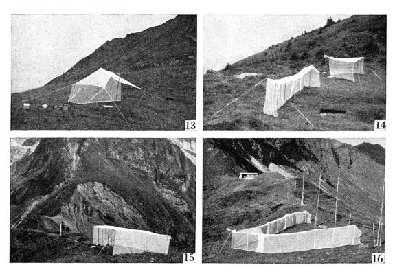
Fig. 13 à 16. — 13. Ecran léger de 4 m. — 14. Au premier plan, écran-barrage de 10 m.; à l'arrière-plan, un filet triangulaire de 4 m. — 15. Grand filet triangulaire de 8 m. — 16. Combinaison d'un filet triangulaire de 4 m. et de deux écrans de 10 m.; l'ouverture de cette installation est d'environ 12 m. et la surface de capture de l'ordre de 24 m².
