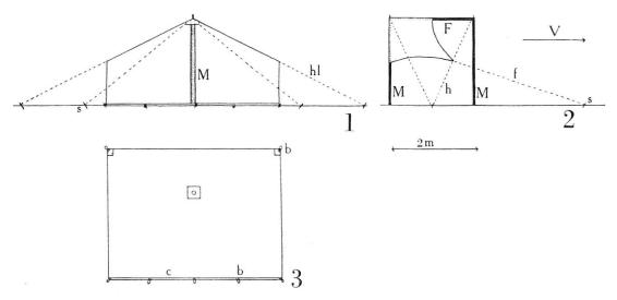
Fig. 1 à 3. Ecran léger de 4 m. — 1. Vue de face. — 2. Vue de profil. — 3. Ecran de térylène étalé, montrant en bas la chevillière de renforcement c, les boucles de fixation b, au milieu l'œillet de fixation au mât et aux angles les boucles b recevant les ficelles de tension. — Autres abréviations : M mât, F barre faîtière, h haubans de 4 m., hl haubans latéraux de 6 m., f ficelles, s sardines, V direction du vent.
