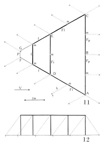
Fig. 11 et 12. Grand filet triangulaire de 8 m. — 11. Vu de dessus. — 12. Vu de profil. — Abréviations: A, B, C mâts postérieurs, D, E mâts latéraux, F, G mâts antérieurs, m mâts secondaires, Fp faîtières postérieures, Fi faîtière centrale, Fl faîtières latérales, f faîtières de 2 m., P porte, h haubans, s sardines, V direction du vent.
