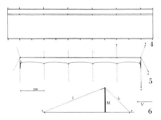
Fig. 4 à 6. Ecran-barrage de 10 m. — 4. Pièce de térylène de 12 m.×2 m. étalée, montrant la disposition des bandes de chevillières, des œillets et des boucles de fixation. — 5. L'appareil vu de dessus. — 6. L'appareil vu de profil. — Abréviations, voir fig. 1 à 3.
