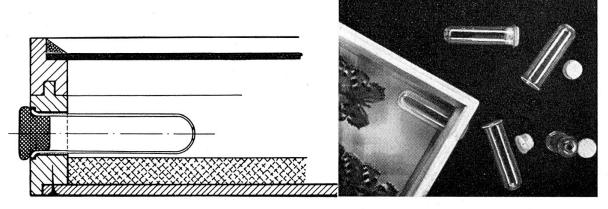
Fig. 1. — Schnitt durch die Vorderwand eines hölzernen Insektenkastens mit eingebauter Giftschleuse.
