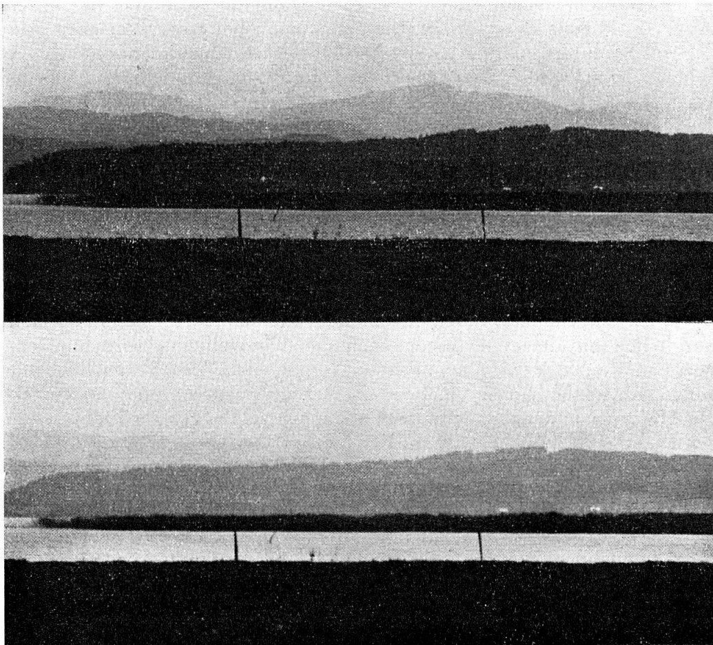
Abb. 21. — Abhängigkeit der Fernsicht von der Wellenlänge des Lichtes. Ausschnitt des Panoramas H auf Tafel II bei leicht dunstigem Wetter mit verschiedenen Lichtfiltern auf Gevaert Duplo Ortho Reproduktionsfilm photographiert; optimale Belichtung. Oben: heller Gelbfilter (GG 3 Schott-Jena), sichtbares Licht 430-580 m\mu . Unten: Ultraviolett Filter (UG 1), um 360 m\mu ; die 3 km entfernte Silhouette des Oberwaldes wird stark aufgehellt und der Schwarzenberg dahinter (12 km) löst sich zu einem wolkenähnlichen Schleier auf.
