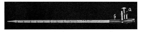
Abb. 1. — Mikropipette zur quantitativen Fütterung der Bienen. — Der Gummischlauch (G) ist am Ende verschlossen, der Quetschhahn (Q) dient zum Aufsaugen und genauen Dosieren der Flüssigkeit. 1 Teilstrich = 1 mm³.
