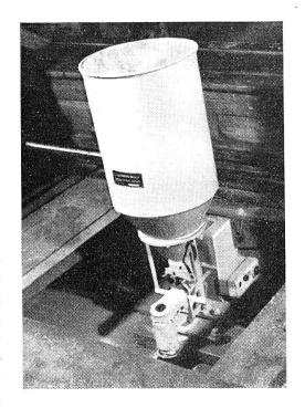
Abb. 6. Dosierungsapparat für Geigy 33. Konstr.: Soder-Geigy.
