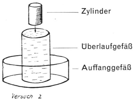
Wir tauchen den Zylinder ins gefüllte Ueberlaufgefäß und messen das verdrängte Wasser. (Messzylinder!) Gleicher Versuch mit dem Kegel. Wir vergleichen die verdrängten Wassermengen.
