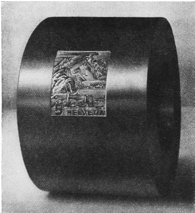
Stahlmolette mit einem positiv geprägten Markenfeld
