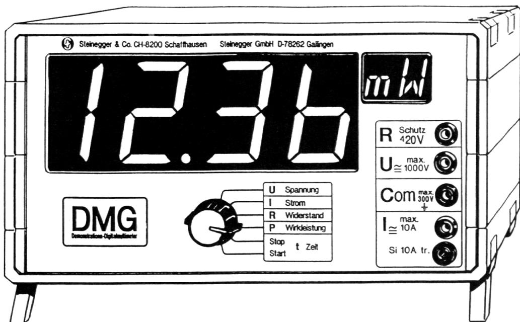
**Das neue vollautomatische Digitalmeßgerät für Schulen;
