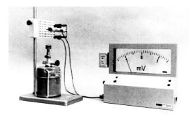
Temperatur messen mit Thermoelement PA 7295
