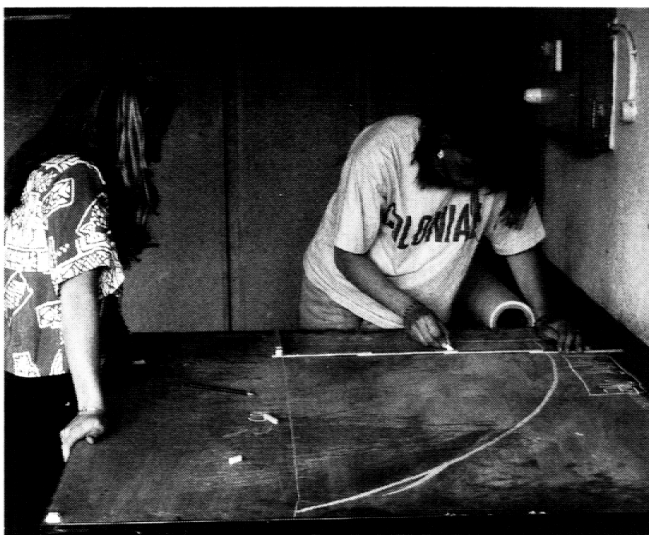
Bild 1 und 2: Die Schüler zeichnen den Verlauf eines Wasserstrahls, der waagrecht aus einem Schlauch spritzt, auf eine Wandtafel und messen dann den Verlauf der Bahn.
