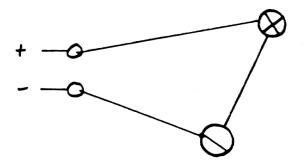
Die einfache Skizze zeigt Stromquelle, Plus und Minuspol, Stromkreis, Glühbirne und offenen Schalter, der den Stromkreis unterbricht.
