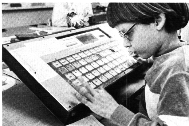
Mit der Kommunikations-Teletthese «Hector» kann ein Behinderter besser mit seiner Umwelt in Kontakt treten. Die Ausgabe der Mitteilungen erfolgt wahlweise über eine synthetische Stimme, einen Bildschirm oder einen Drucker. Das Gerät wird entwickelt durch die 1982 gegründete «Schweizerische Stiftung Elektronischer Hilfsmittel für Behinderte» in Neuchâtel.
