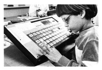
Mit der Kommunikations-Telethese «Hector» kann ein Behinderter besser mit seiner Umwelt in Kontakt treten. Die Ausgabe der Mitteilungen erfolgt wahlweise über eine synthetische Stimme, einen Bildschirm oder einen Drucker. Das Gerät wird entwickelt durch die 1982 gegründete «Schweizerische Stiftung Elektronischer Hilfsmittel für Behinderte» in Neuchâtel.
