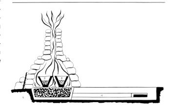
Abb. 1: In Ex 19,18 wird der Sinai mit einem Schmelzofen verglichen. Durch einen Kanal (1) wird die Luft an die Kohlen (2) herangeführt, deren Glut das Kupfer in den irdenen Töpfen (3) zum Schmelzen bringt. Rauch und Feuer schlagen zum vulkanartig aufgebauten Kamin hinaus.
