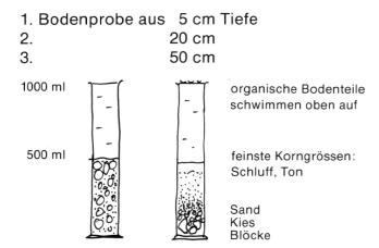
In einen Messzylinder (Plastik, durchsichtig, 1000 ml) wird bis zur Hälfte der Höhe Erde eingegeben und bis 1000 ml mit Wasser nachgefüllt. Der Messzylinder wird mit der Handballe gut abgedeckt und der Zylinder samt Inhalt gründlich durchgeschüttelt und auf ebene Unterlage abgestellt. Die Bodenbestandteile senken sich ab und ordnen sich dabei von selbst nach der Korngrösse.
