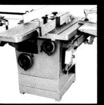
Nur LUREM bietet Ihnen: Abrichten, dickenhobeln, kreissägen, kehlen, langlochbohren alles in einer Maschine. Massive Gusskonstruktion. SUVA-geprüft.
