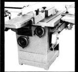
Nur LUREM bietet Ihnen: Abrichten, dickenhobeln, kreissägen, kehlen, langlochbohren alles in einer Maschine. Massive Gusskonstruktion. SUVA-geprüft.
