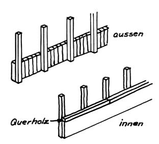
11. Von den kurzen, vorbereiteten Hölzchen werden je fünf hinter zwei senkrechte Stützen geklebt. Immer einen Zwischenraum als Fenster offenlassen. Oben haben nachher noch ungefähr zwei Reihen Querhölzchen Platz (durchgehend).
