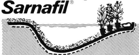
Die grüne Sarnafil-Kunststoff-Dichtungsbahn wurde speziell für die Abdichtung von Teichen und Biotopen geschaffen. Sie genügt den hohen Anforderungen (mechanische Beanspruchung, Wurzelbeständigkeit usw.) und passt sich der natürlichen Umgebung farblich an. Sarnafil-Abdichtungsbahnen werden nach Massiv Werk (bis ca. 80 m<sup>2</sup>) angefertigt, bei grösseren Anlagen auf der Baustelle.
