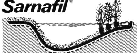
Die grüne Sarnafil-Kunststoff-Dichtungsbahn wurde speziell für die Abdichtung von Teichen und Biotopen geschaffen. Sie genügt den hohen Anforderungen (mechanische Beanspruchung, Wurzelbeständigkeit usw.) und passt sich der natürlichen Umgebung farblich an. Sarnafil-Abdichtungsbahnen werden nach Mass im Werk (bis ca. 80 m<sup>2</sup>) angefertigt, bei größeren Anlagen auf der Baustelle.
